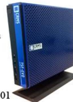
Variante autonome de la plateforme TSF-EVO, la solution CR-DP-EVO permet via le protocole SIP\* la gestion de messagerie texte DECT ou IP-DECT d'un appel infirmière autre que CRMS et la gestion d'alarmes techniques.
