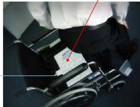
Tapis de détection A placer sur l'assise du fauteuil
